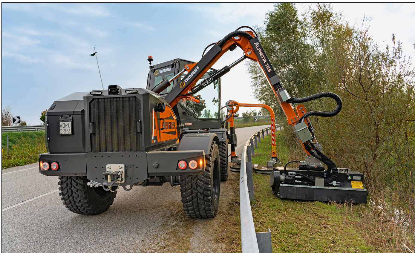
Placeringen af armen til venstre for maskinens midte giver høj stabilitet både under kørsel og når maskinen arbejder.
