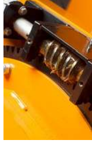
Snäckväxel är standard på samtliga Trejon Optimal snöfräsar. Denna är självrensande och håller utkastarröret fäst i önskat läge.
