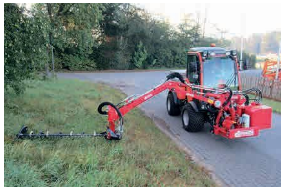
DMW dobbeltklinge-klipper i brug på KBM 350
