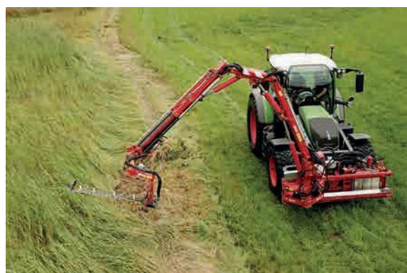
Anvendelse af DMW til vedligeholdelse af skråninger
